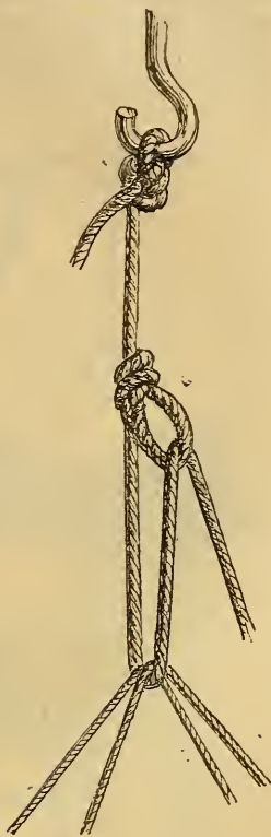
Fig. 145. — Corde à suspension. Disposition indiquée par Mayor pour remplacer la poulie.
